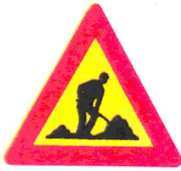
(K - 20) Κίνδυνος λόγω εκτελουμένων εργασιών στην οδό.
